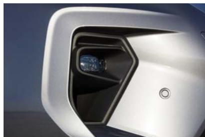
LED-Nebelscheinwerfer mit Kurvenlicht-Technologie\*
