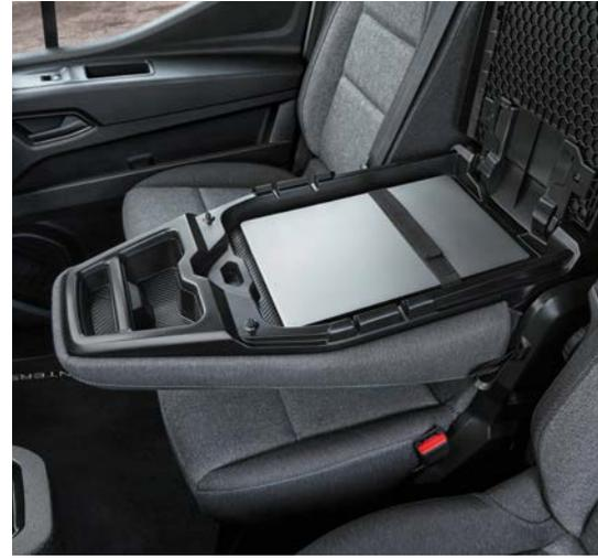
Arbeitsfläche bei umgeklapptem Mittelsitz<sup>1</sup>
